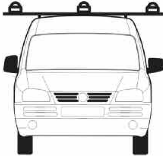
Ilustración 2 : Disposición de sensores: Método dinámico de medición de iluminancia y uniformidad
